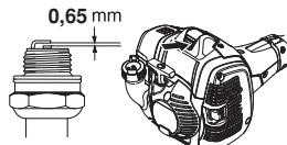
**ВНИМАНИЕ!** Всегда используйте только указанный тип свечи! Применение несоответствующей модели может привести к серьезным повреждениям поршня/цилиндра. Следите за тем, чтобы свеча была оснащена т.н. изоляцией радиопомех. См. Раздел Технические характеристики.
