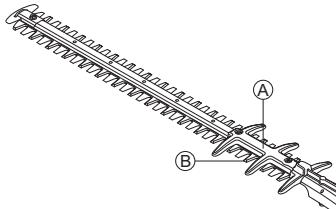
Проверьте щиток ножа, чтобы он не был поврежден и деформирован. Погнутые или поврежденные щитки лезвий необходимо заменять.
