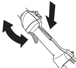
См. указания в разделе Пуск. Запустите ножницы для живой изгороди и откройте полностью газ. Отпустите ручку газа и проверьте, чтобы ножи останавливались и оставались неподвижными. Если ножи врашаются на холостом ходу, отрегулируйте холостой ход карбюратора. См. раздел Техническое обслуживание.
